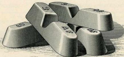
Le métal antifriction remplace avec supériorité le bronze et le laiton dans la fabrication des coussinets, qui, fabriqués avec ce métal, nécessitent beaucoup moins de graissage que ceux coulés avec d'autres métaux et ont, en outre, l'avantage de ne pas s'échauffer ni de s'encrasser.
